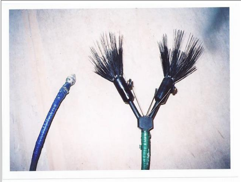
〇〇〇ビル 空調換気ダクト清掃工事 清掃ツール 高圧エアロボット
